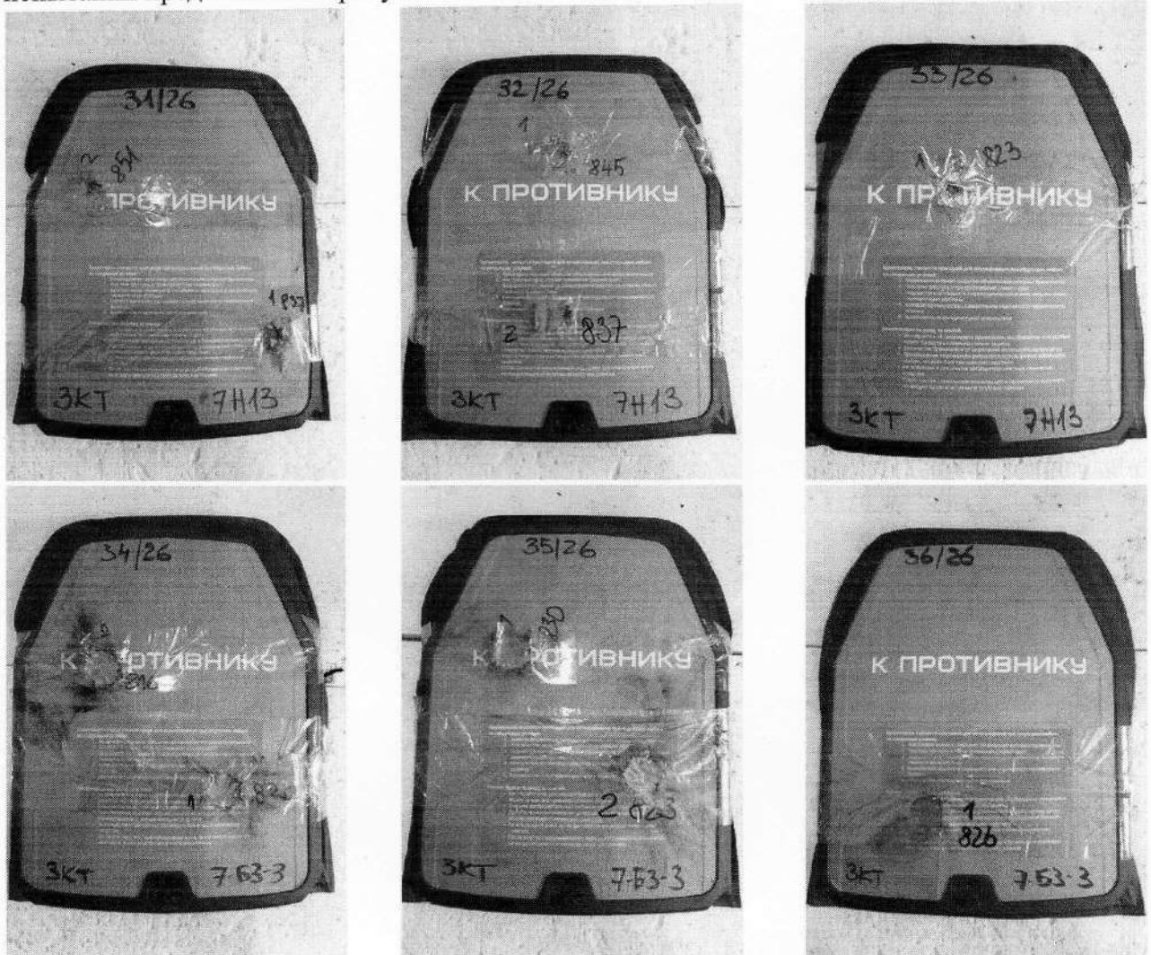
Рис. 3.3 – Внешний вид бронепанелей керамо-композитных Бр5 «Оксид» после проведения испытаний.
