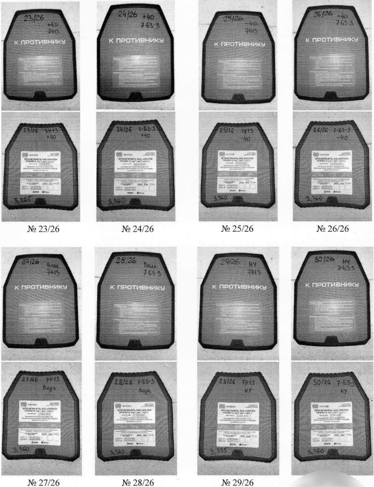
Рис. 2.1 - Внешний вид бронепанели керамо-композитной Бр5 « Испытания проводились в соответствии с требованиями «Бронеодежда. Методы испытаний» п. 4.3.1.
