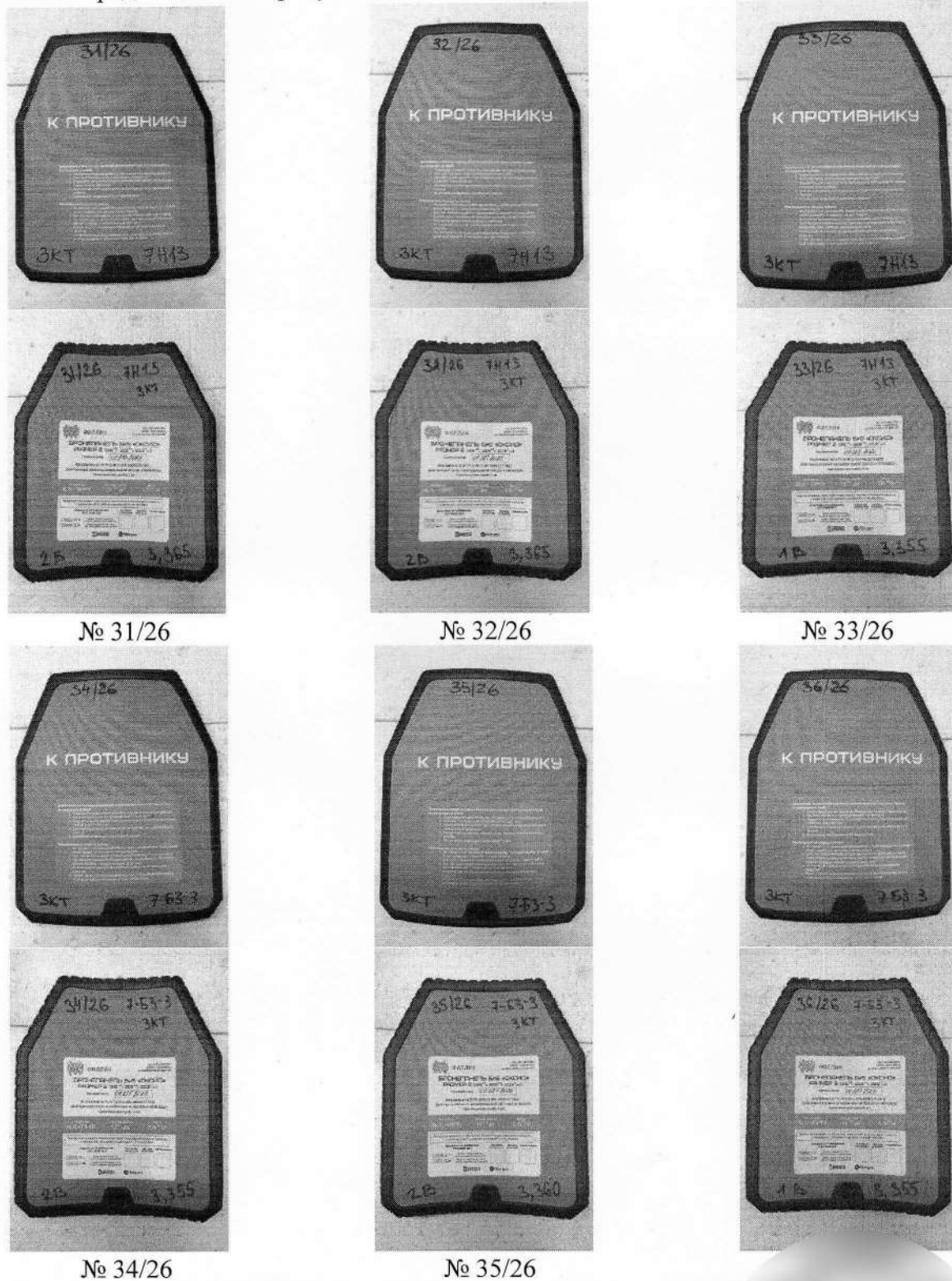
Рис. 3.2 – Внешний вид бронепанелей керамо-композитных Бр5 проведения испытания.
