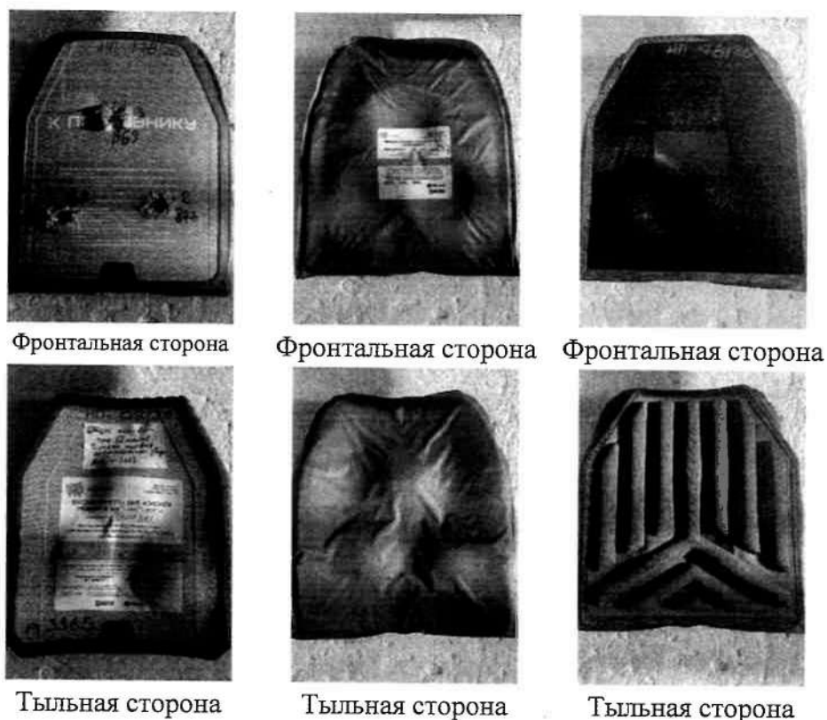
Рис. 2 - Внешний вид БП «Оксид» (№178/26) совместно с мягким противоосколочным пакетом и Демпфером-КАП после испытаний.
